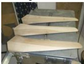
Für die Rotorblätter verwendet GREEN STEP e.V. Flügel aus lokal verfügbarem Holz. Der höhere Arbeitsaufwand wird durch die einfache Herstellung ohne Spezialwerkzeug, das nahezu unerschöpfliche Angebot an Baumaterial Holz und die individuellen Anpassungsfähigkeit einzelner Rotoren an die jeweiligen Windgeschwindigkeiten des Standortes mehr als ausgeglichen. Damit die Windkraftanlagen der wechselnden Windrichtung folgen können, sind sie mit einer Windfahne am hinteren
